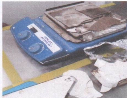
Plat Heater yang terdampak rusak
