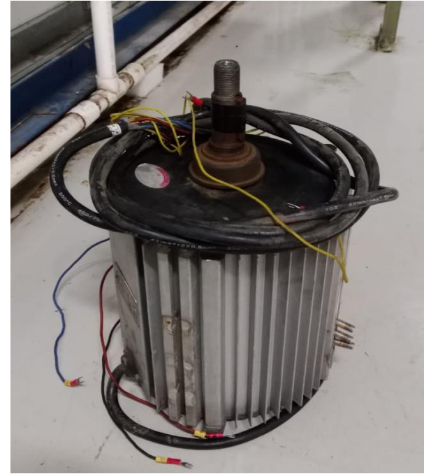
Motor Fan Chiller 6 No.1
